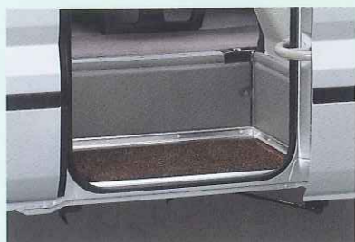
② 足拭き付ステップ ●写真はセンタードア(グライドドア・手動)
