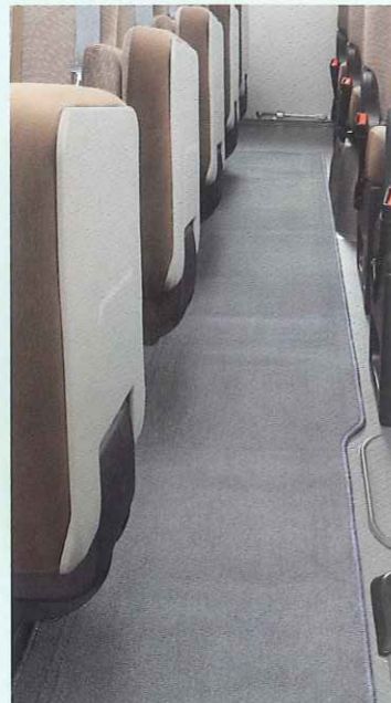
③ 通路カーペット(カットパイル)
