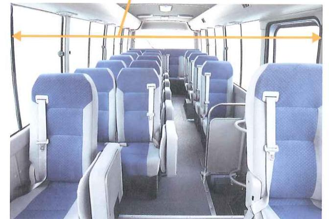
\*1 乗車定員25人～29人乗りのマイクロバスクラス。室内長(ロングボディ車:6310mm、標準ボディ車:5590mm)、シート幅(2人席:910mm、1人席:465mm)。2012年6月現在 自社調べ(他社にも同シート幅のクルマがあります)。
